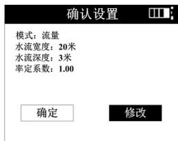
图 28a 连续测量确认设置
